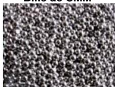
L'acier CMM est acheté en billes, fondu dans un four à fusion, puis injecté dans un moule à haute pression qui façonne directement l'objet. Grâce à plusieurs brevets déposés par nos ingénieurs, le produit démoulé ne comporte pas d'arêtes et rend inutile l'ébavurage. Par ailleurs, la surface présente un aspect lissé uniforme qui rend inutile un brossage. Tous les produits fabriqués sont standards et nécessitent le même travail et la même quantité d'acier. seul le moule change.
